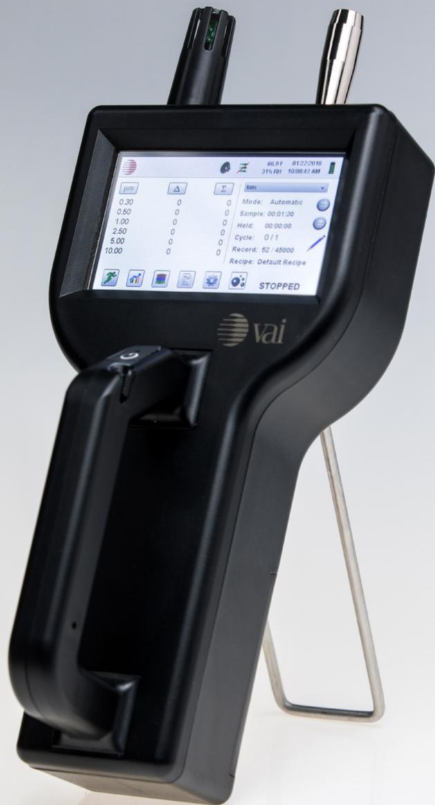
El contador de partículas portátil SMA MicroParticle ICS tiene 6 canales y mide partículas de 0.3 micras a 25.0 micras a una velocidad de flujo de 0.1 CFM (2.83 LPM).
